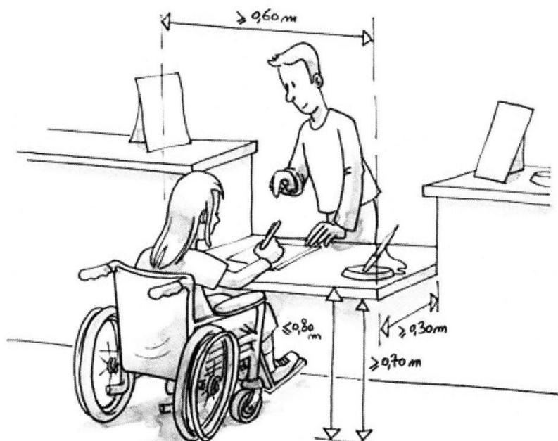
Les **comptoirs et banques d'accueil** doivent aussi être accessibles : une partie d'au moins 60 cm de largeur et 30 cm de profondeur doit être abaissée entre 70 cm et 80 cm pour permettre à une personne en fauteuil de s'avancer dessous.
